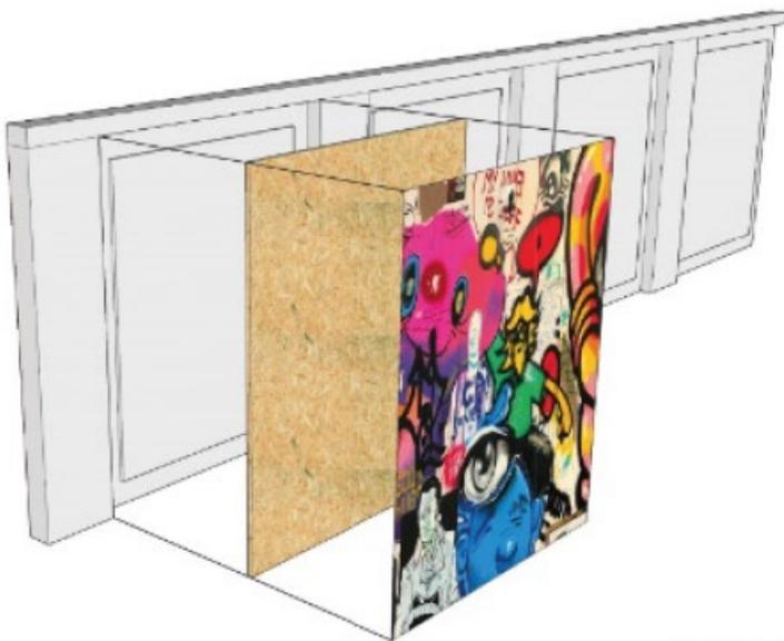
Il riquadro di muro viene rivestito da due pannelli accostati in compensato tipo okoumè fenolico, sp. mm.18, di dimensioni commerciali 310 x 153 cm
